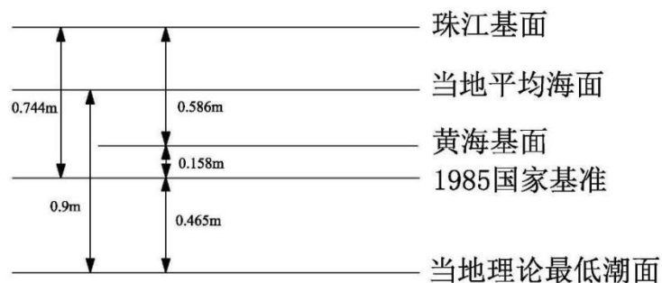
图 3.2.2-1 汕尾海洋站基面高程关系示意图
