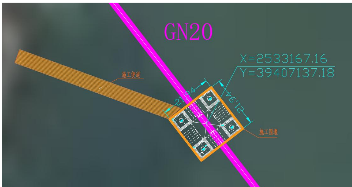
图 2.2.2-1 GN20 塔基涉海桩基布置示意图
