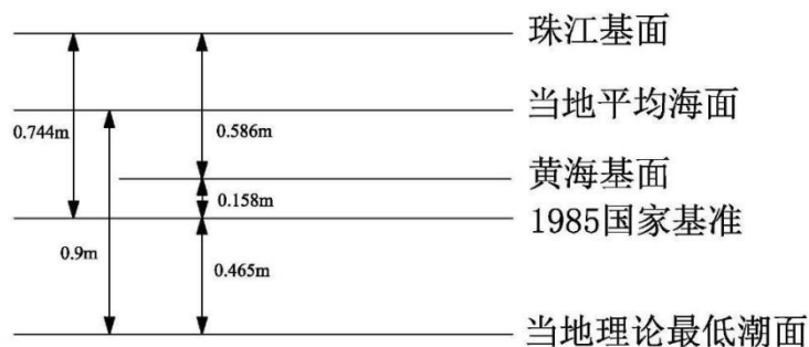
图 3.2.2-1 汕尾海洋站基面高程关系示意图
