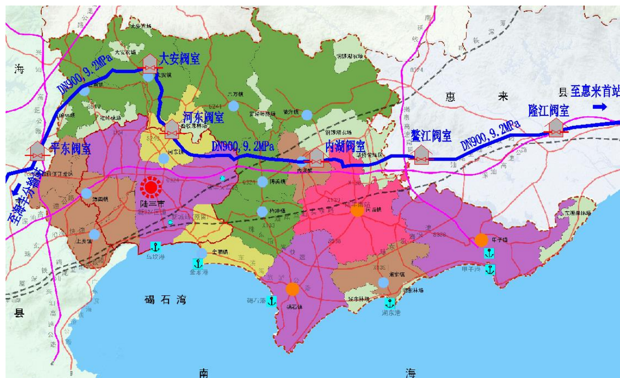
图 5.1.1-1 陆丰市域长输管线及阀室分布示意图
