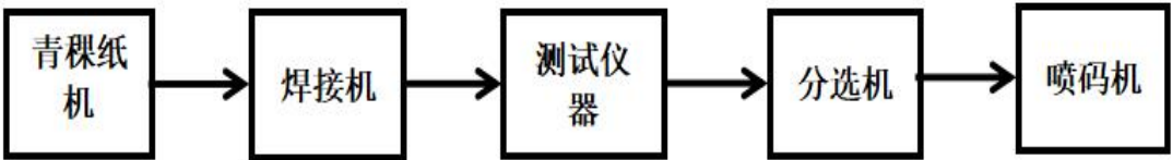
图 2-7 派克电池工艺设备连接示意图
